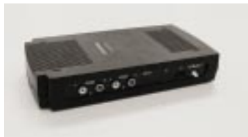
Ansicht Vorderseite WT2: NF-Eingänge/ Install-Taster/Antenne/I2C-Bus-Buchse/ Kanalwahlschalter
